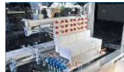
Ein Schubert TLM-F2 Roboter erzeugt eine komplette Lage der Primärkartons und setzt diese in die zuvor geöffnete Faltschachtel.
