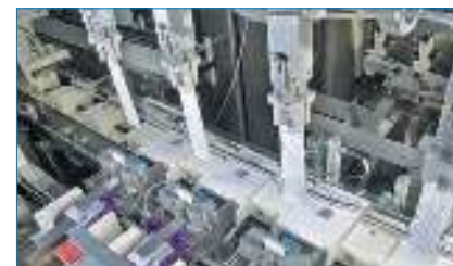
Vierfach entnehmen Schubert TLM Systemkomponenten (Zuschnittmagazin, Übergabeaggregat und der TLM-F2 Roboter) die vorverklebten Zuschnitte und übergeben diese an das TLM Transportsystem.
